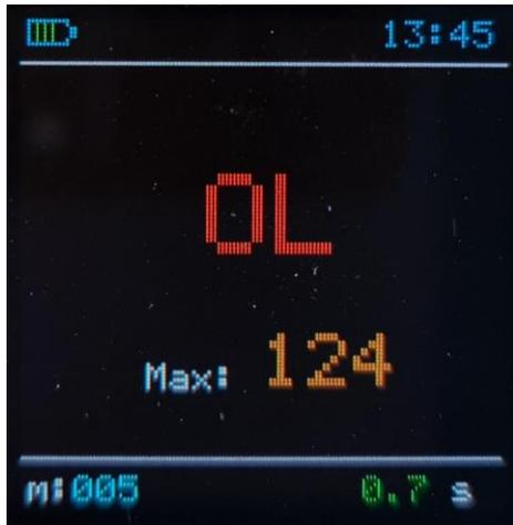
Diese Meldung bedeutet, daß der Messwert höher als 125 Standard Skalenteil [Nrm] liegt. Einfach durch Drücken des (I)-Tasters nach unten wieder löschen. Sie können dann eine erneute Messung durchführen.
